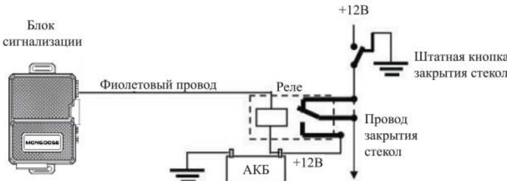
**Подключение дополнительного канала 1 для реализации функции «Поддержка зажигания/Турбо таймер»**
