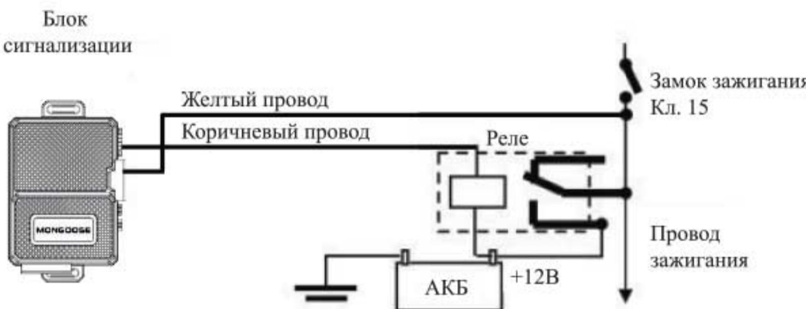
**Подключение нормально разомкнутого реле блокировки**
