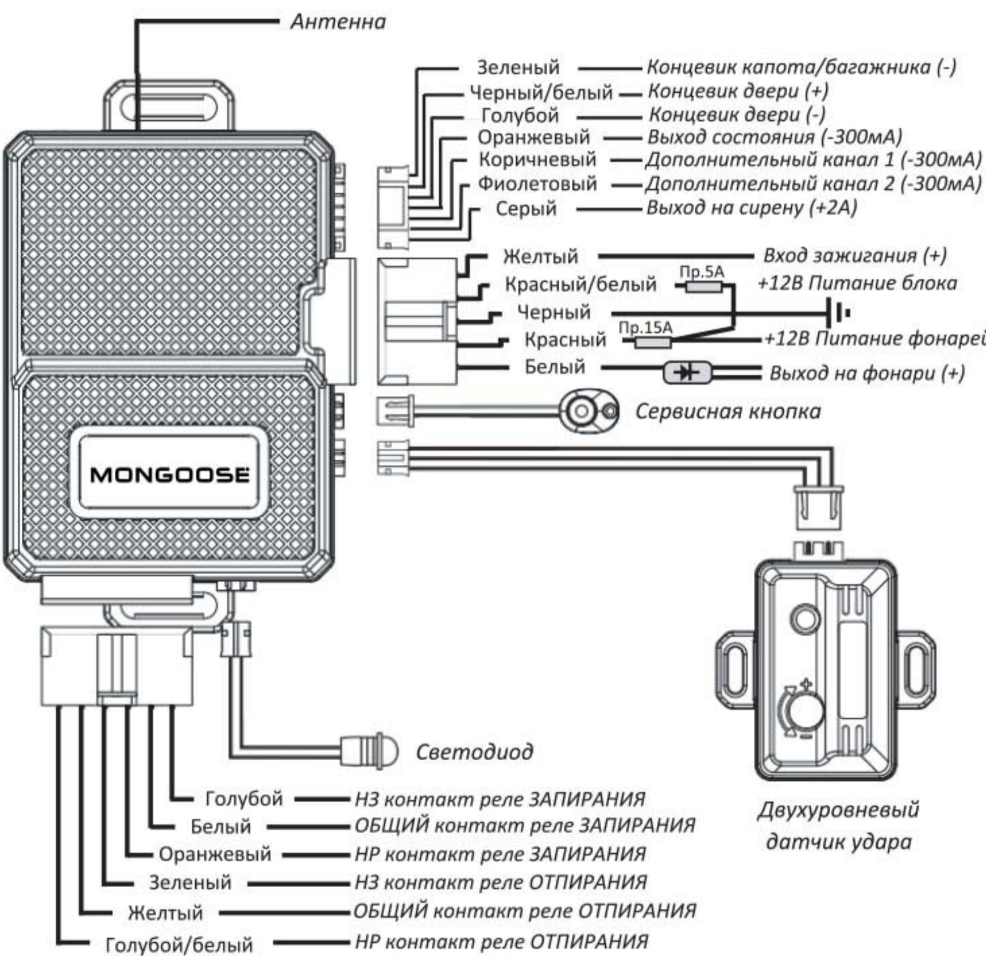
**Назначение проводов и разъемов центрального блока.**
