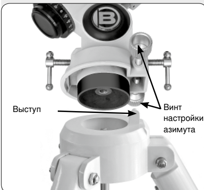
Рис. 5: Установка монтировки на треногу
