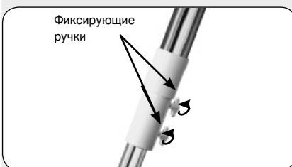
Рис. 11: Отрегулируйте высоту штатива при помощи фиксирующих ручек.
