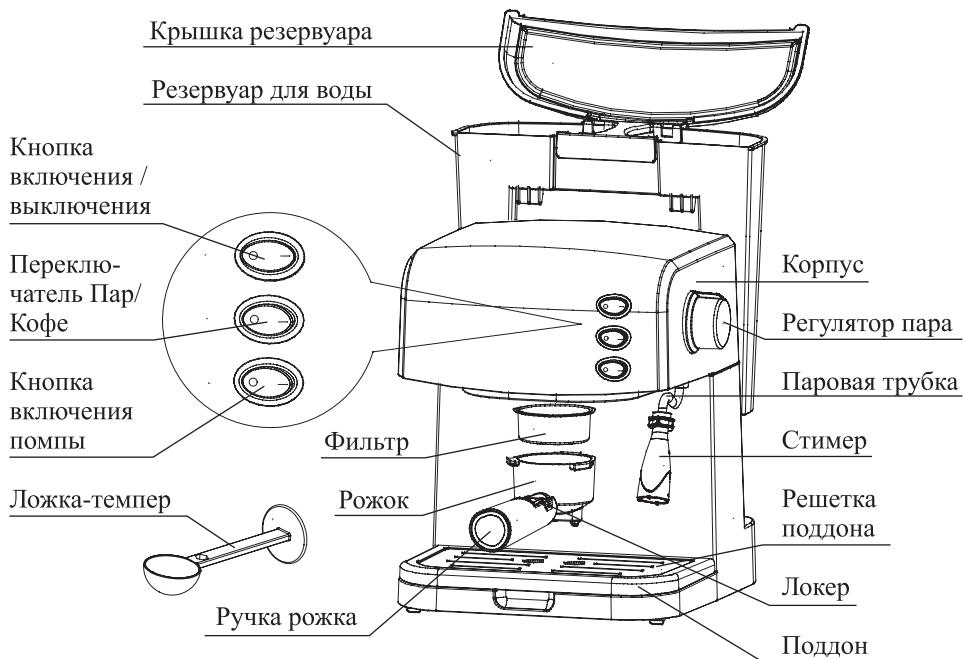
Каждая кнопка на панели управления оснащена световым индикатором, показывающим состояние работы.
