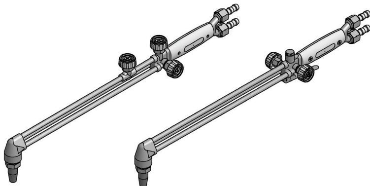
Резак состоит из головки, вентиля горючего газа (ГГ), подогревающего кислорода (КП), режущего кислорода (КР) (или клапана с рычагом), ручки и присоединительного блока с гайками и ниппелями. Все элементы резака соединены между собой трубками (соединение неразборное).
